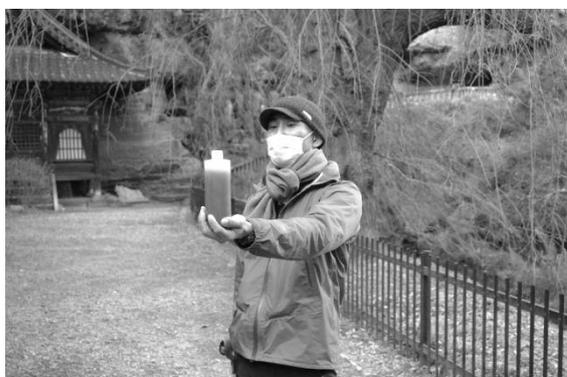
実験道具「エキジョッカー」。名前の通り液状化を再現するアイテムで、これを使って縞々の地層に縦のラインが入った原因を探る。このボトルに振動を与えると……。参加者も手に持って試してみる。
